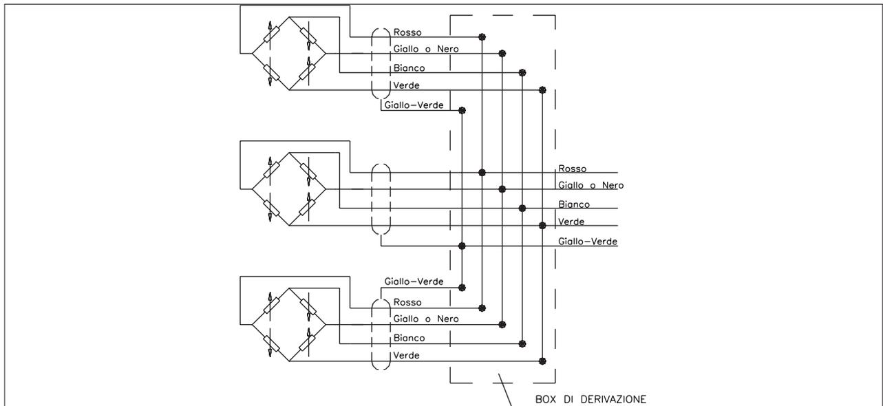
Nei sistemi che utilizzano più celle, la connessione in parallelo consente l'automatica somma dei carichi agenti sulle singole celle. Questo sistema di misura avrà come carico massimo la somma dei carichi delle singole celle e come sensibilità il valore medio delle sensibilità delle stesse. E' importante che l'utilizzatore si assicuri che per ogni condizione di carico, nessuna cella sia sollecitata oltre il carico massimo.
