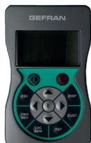
Una piattaforma potente ma allo stesso tempo con una struttura menu/parametri di rapida interpretazione, facilitata ancor più dalle funzionalità della tastiera e dal display. Navigazione assolutamente intuitiva e funzioni di startup immediate grazie al tool "Wizard" AFE200 offre come standard la programmazione in 10 lingue (Inglese, italiano, Francese, Tedesco, Spagnolo, Polacco, Rumeno, Russo, Turco e Portoghese).
