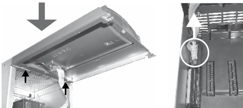
3. Per evitare di danneggiare il collegamento del tastierino, la copertura superiore può essere posizionata come indicato in figura. In alternativa per rimuovere il connettore del tastierino e appoggiare la copertura in un luogo sicuro.
