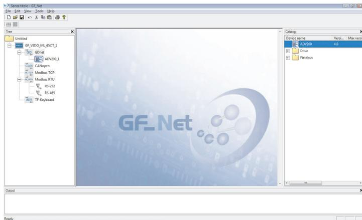
E' quindi possibile configurare le impostazioni del drive , il node number e un file Gf\_eXpress con la configurazione dei dati scambiati :
